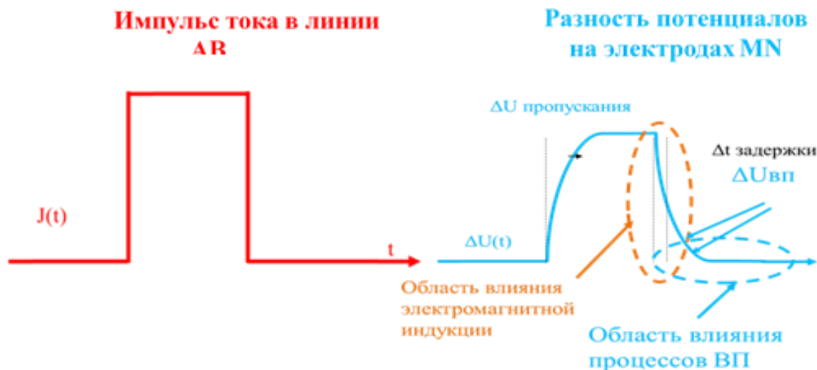
Рис. 1. Форма импульса тока в генераторном диполе АВ и разность потенциалов, возникающая на приемной линии MN
