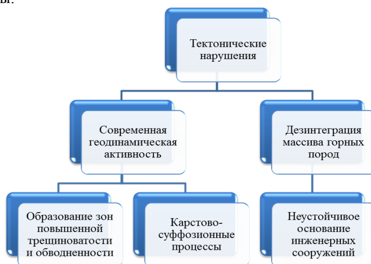
Рис. 3. Взаимодействие тектонических нарушений и геологической среды
