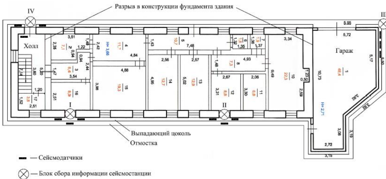
Рис. 2. Схема расположения сейсмологического оборудования
