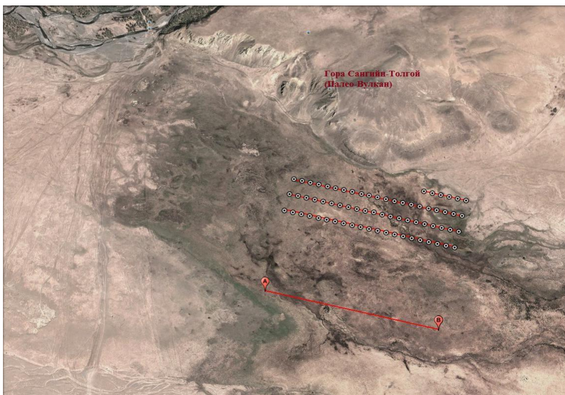
Рис. 1. Участок проведённых работ с расположением приемных и питающих линий
