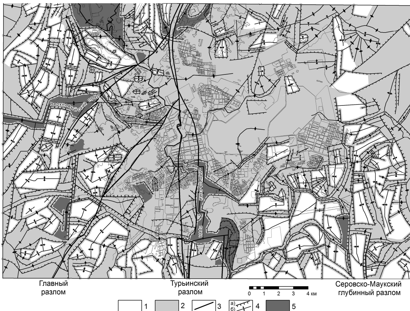
Рис. 1. Схематическое районирование территории города Нижний Тагил Свердловской области по величине расчетной силы сейсмического воздействия.
