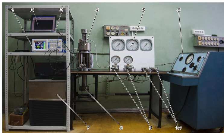
Рис. 3. Общий вид установки для моделирования гидратосодержащих образцов и измерения их акустических свойств: 1 - генератор импульсов АКПП-3305, 2 - компьютер, 3 - цифровой осциллограф АКПП-72208А, 4 - камера высокого давления с термостатирующей рубашкой, 5 - блок стрелочных манометров, 6 - насосная установка, 7 - термостат Huber Ministat, 8 - гидроцилиндр, 9 - порты для подачи газа/жидкости к образцу, 10 - вентили осевого и бокового давления.
