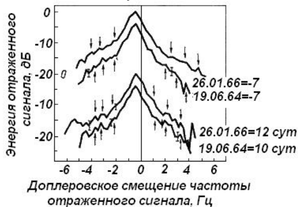
Рис. 2. Доплеровские спектры, полученные на длине волны 39 см вблизи нижних соединений Венеры (соответственно 19 июня 1964 г. и 26 января 1966 г.).
