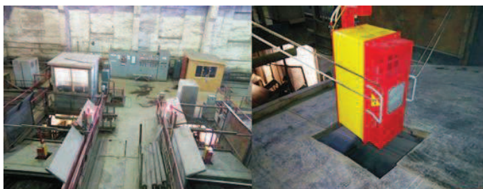
Рис. 1. РКС РЛП–21Т на конвейерах №1 (слева) и № 2 (справа) КД–2 ЖОФ–2. Общий вид РКС РЛП–21Т
