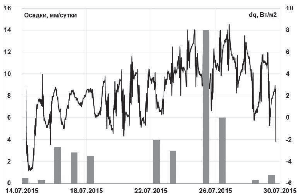
Рис. 3. Сопоставление разности измеренного и вычисленного тепловых потоков (черная кривая) и количества выпавших осадков в мм (серая гистограмма)
