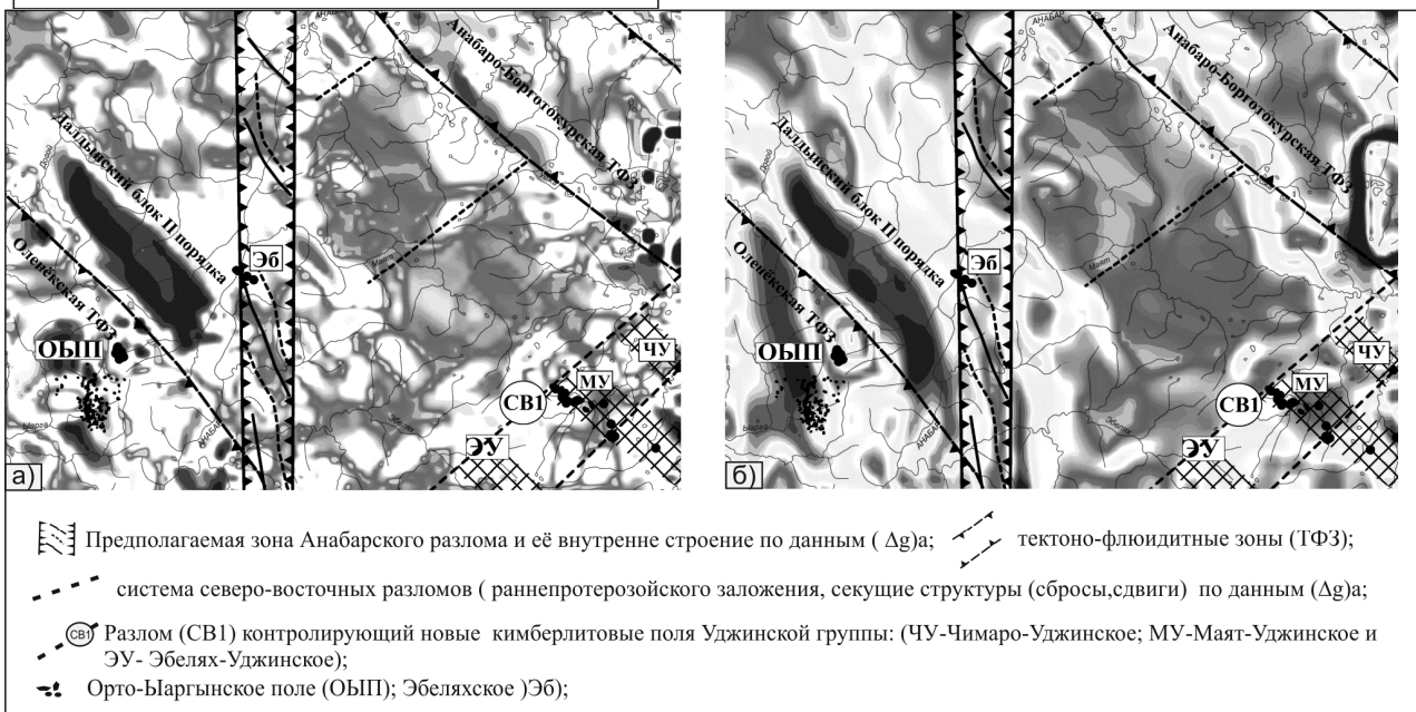
Рис. 2 Пространственные данные поля силы тяжести: статистическое зондирование (а-дисперсия); градиентное (б-полный градиент) с кимберлитовыми полями Уджинской группы.
