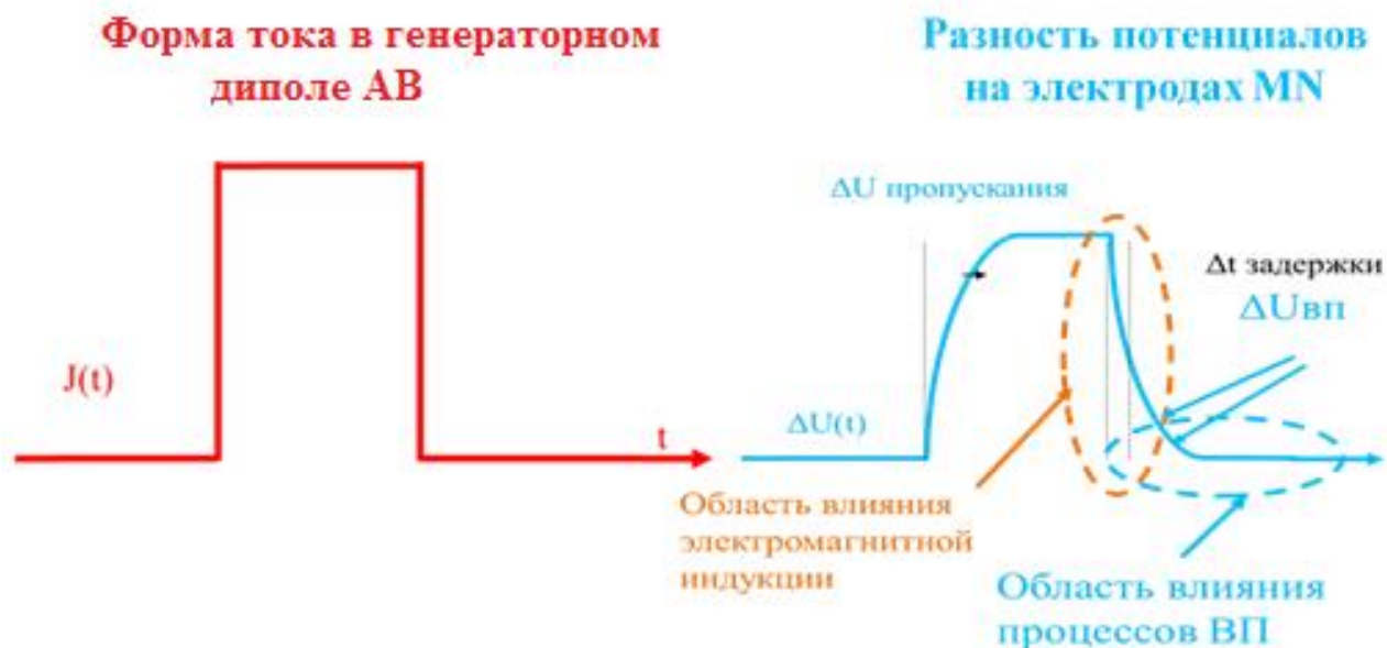
Рис. 1. Форма импульса тока в генераторном диполе АВ и разность потенциалов, возникающая на приемной линии MN.
