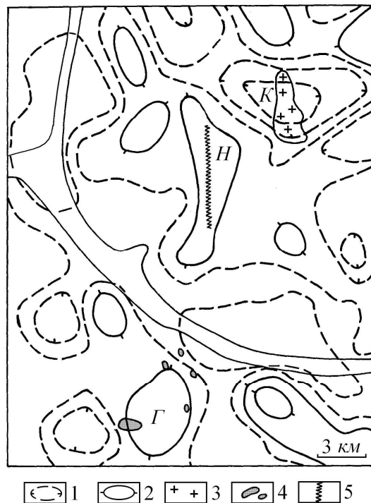
Рис. 2. Схема локальной составляющей гравитационного поля района Нежданинского месторождения золота: 1, 2 – аномалии гравитационного поля: 1 – минимумы (K – Курумский), 2 – максимумы (H – Нежданинский, Г – Гельдинский); 3 – гранитоиды Курумского массива; 4 – диориты Гельдинских штоков; 5 – рудная зона № 1 Нежданинского месторождения
