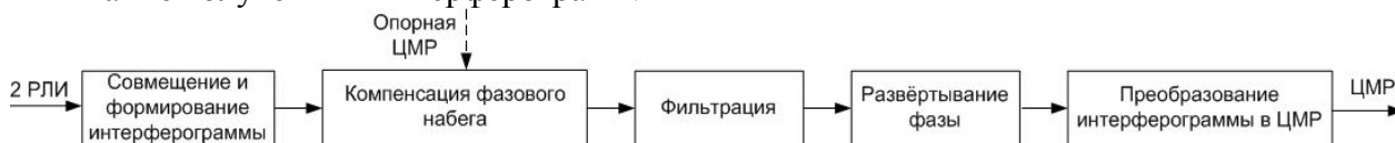
Рис. 1 — Этапы интерферометрической обработки данных космических РСА
