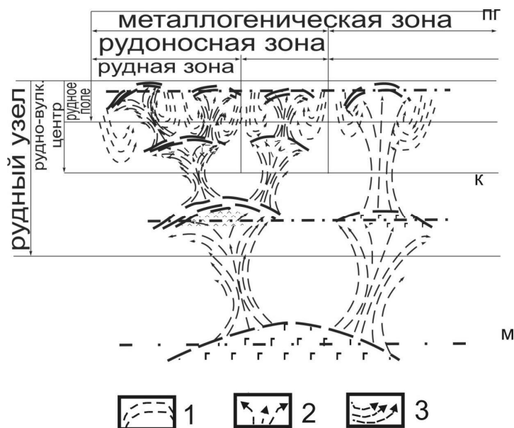
Рис. 2. Структура сейсмогеологических границ в модели рудно-магматической системы. Горизонты отражения упругих волн (1) от акустических неоднородностей в палеозонах геохимических и геодинамических барьеров разгрузки трансмагматических флюидов (2) и конвективных потоков (3) нисходящих морских вод и восходящих
