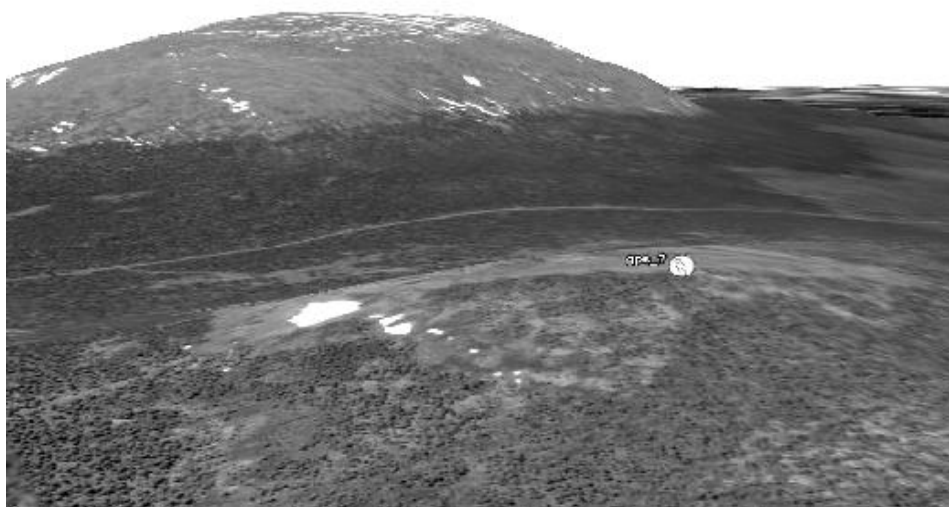
Рис. 2. Пример выявления оптимальных пунктов GPS-мониторинга по космическим снимкам высокого разрешения с построением псевдопанорамы. Район горы Сосьвинский Камень
