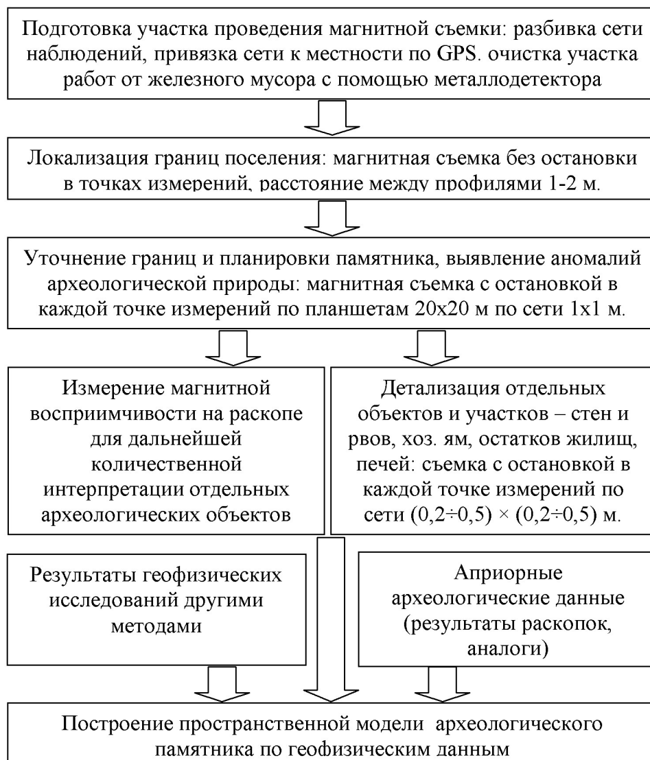
Рис.2. Блок-схема поэтапного магнитометрического обследования археологических памятников.
