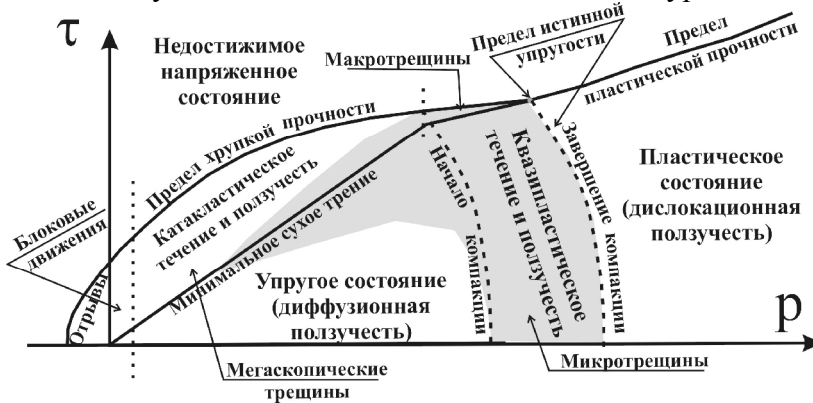
Рис. 4. Распределение на диаграмме Мора различных типов поведения горных пород, возникающих при разных уровнях максимального касательного напряжения и всестороннего давления. Серым цветом на диаграмме Мора выделены предполагаемое положение участков, отвечающих телу разлома там, где имеет место милонитизация пород и пластическое их поведение.
