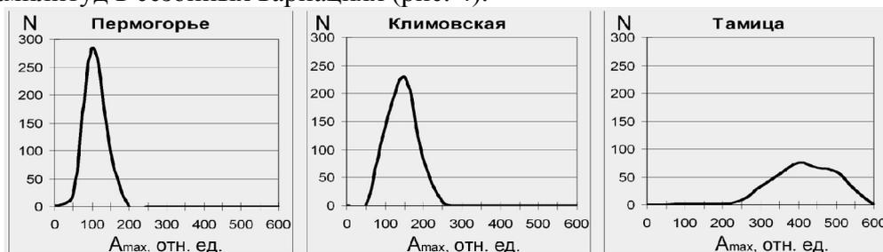
Рисунок 5. Распределения максимумов спектральных амплитуд в течение времени одной квазигармонической наводки по совокупности разных случаев на записях трех станций Архангельской сейсмической сети (канал SHE).
