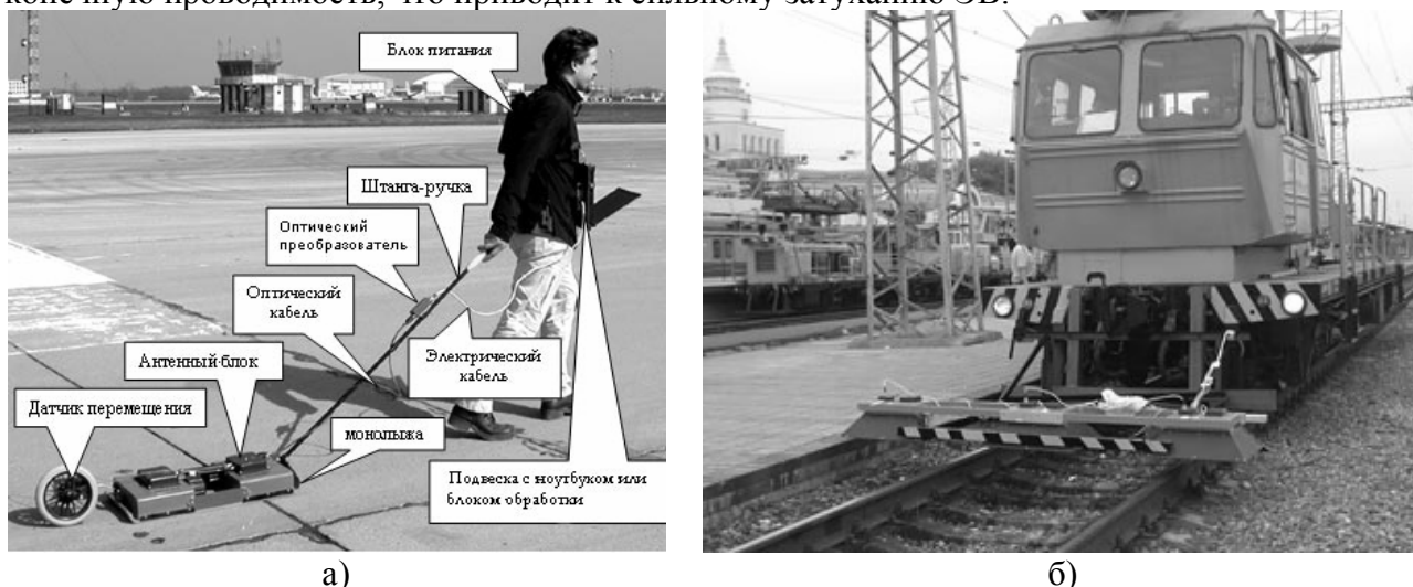
Рис. 1 Аппаратурная реализация георадаров: а) – георадар ОКО [2]; б) трехканальный георадарный комплекс с рупорными антеннами [3]
