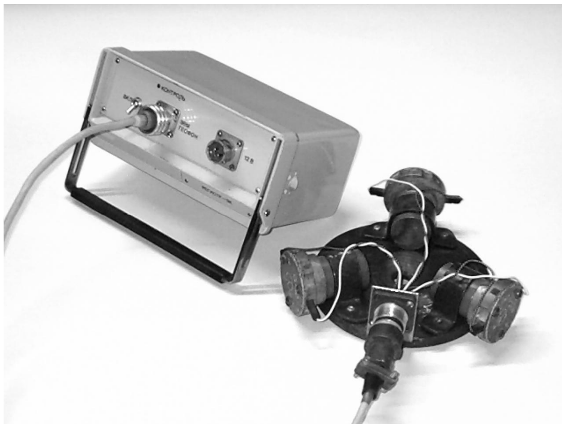
Рис. 2. Внешний вид регистратора сейсмических сигналов «Регистр» с 3-компонентным электродинамическим датчиком.
