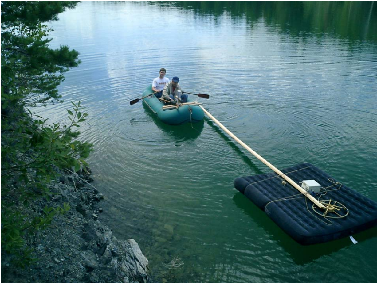
Индуктивная электроразведка на акваториях при поисках подводных объектов в Свердловской области, 2006 г. В лодке – студент УГГУ А.А. Шмидт и С.В. Байдиков
