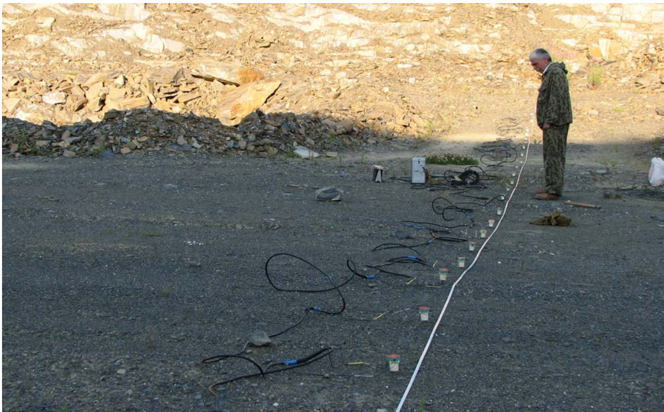
Подготовленный к работе сейсмический профиль. На заднем плане сейсмическая станция «Синус-24М». (Л.Н. Сенин). Суранское месторождение флюорита, лето 2007 г., Республика Башкортостан
