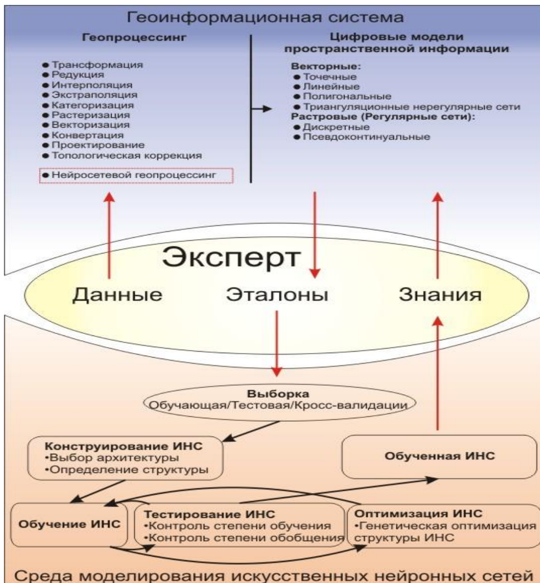
Рис.1. Предлагаемая концепция нейросетевого геопроцессинга на основе интеграции среды моделирования ИНС и ГИС
