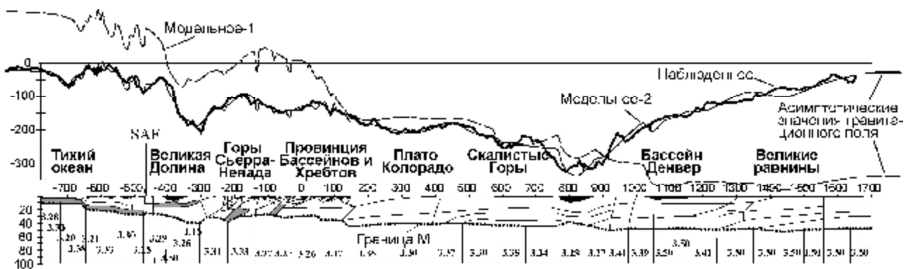
Рис.2. Блоковая структура коры вдоль профиля «Колорадо» (положение профиля см. Рис.1) и результаты плотностного моделирования. SAF - разлом Сан-Андреас.Серой заливкой в коре показаны: слева от разлома Сан Андреас – современная океаническая кора, справа от разлома Сан Андреас – реликты аккрецированных к окраине Северной Америки офиолитовых комплексов. Черной заливкой показаны осадочные бассейны, активизировавшиеся в кайнозойское время. Цифры в мантийных блоках – плотности для Модели 2.
